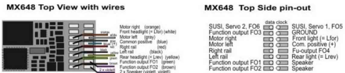
Por encima del cable blanco de la luz delantera he soldado el cable negro de la masa al pad llamado GROUND. El descodificador de Zimo tiene la particularidad de que los cables del altavoz son violetas, y el cable de la función F2 es de color marrón (al revés que otros fabricantes). En la foto se puede comprobar como queda el descodificador con los cables conectados a un interfaz NEM651 (que no tiene el común positivo -azul).
